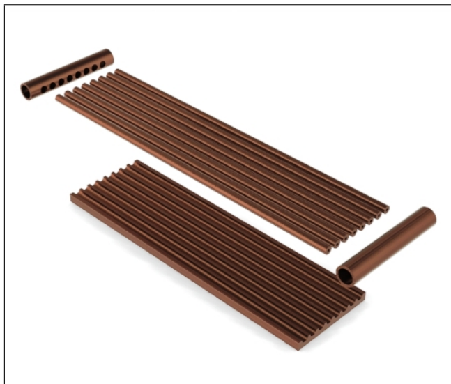
Figura 3.6: Esquema da montagem dos microcanais com a chapa de cobre e os manifolds de entrada e saída.
