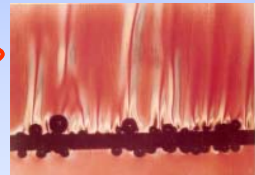
Ebullition sur un fil de platine «Technique Schlieren», in Jabardo (2008)
