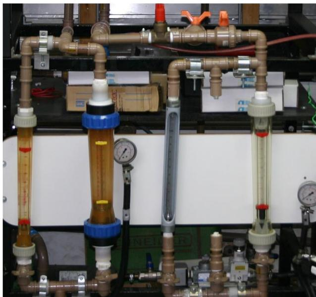
Figura A.10 – Rotômetros para água (à esquerda) e para ar (à direita).
