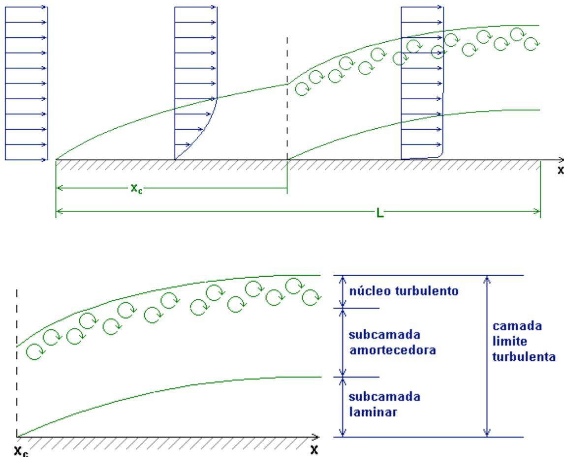
Figura 3: Camadas limites laminar e turbulenta
