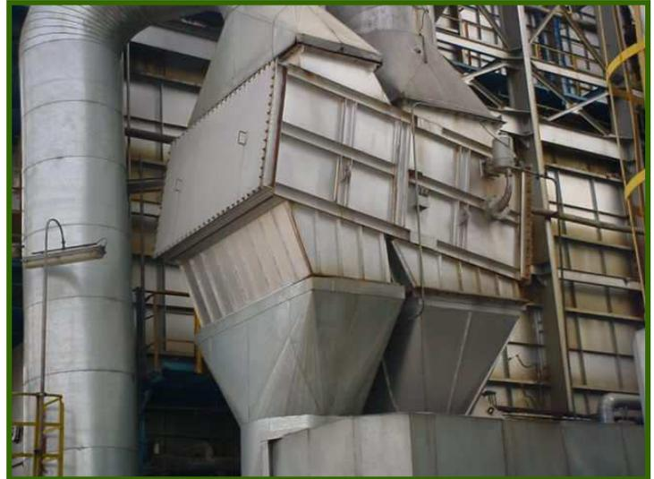
Figura 1.15. Trocadores de calor com termossifões empregados na indústria na China.
