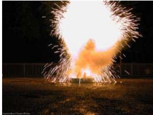
Figura 2-2 – Explosão de 50 g a 175g de sódio imerso em água.
