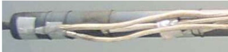
Figura 4-14 – Visão da extremidade dos termopares com fita alumínio sobre fita de vidro.
