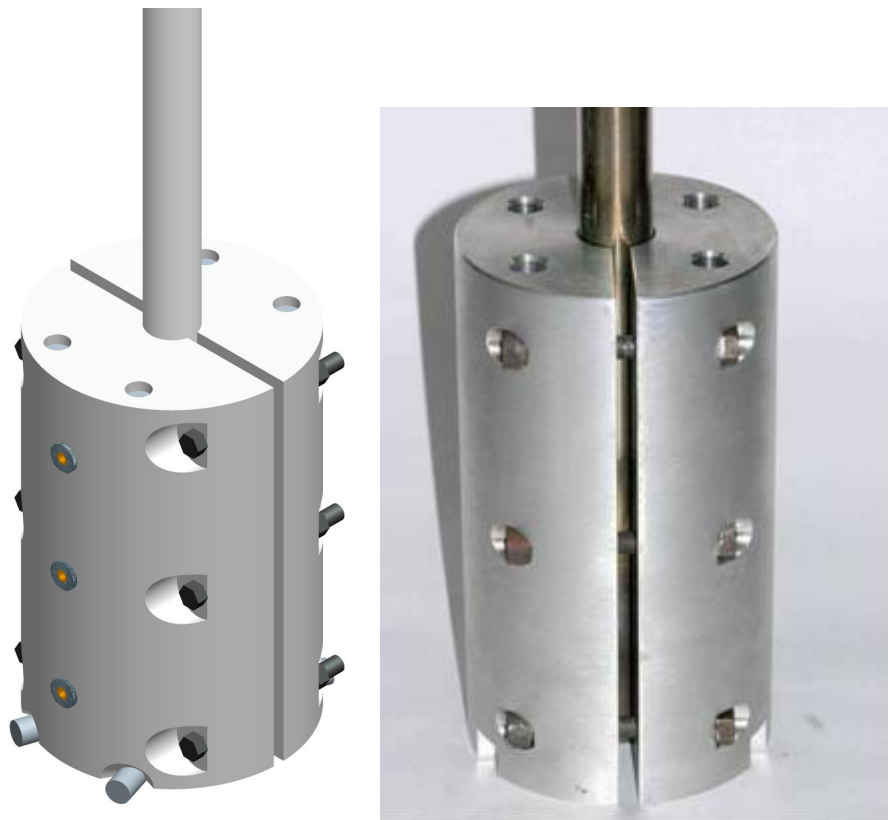
Figura 4.6 – Descrição detalhada do bloco de aquecimento do evaporador: (a) Croqui; (b) foto do aparato
