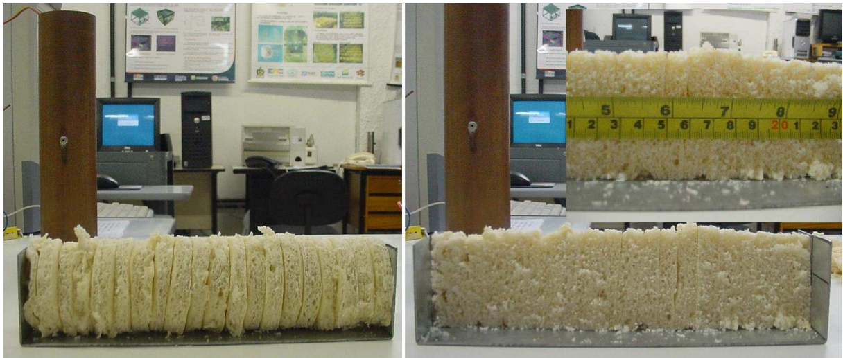
Figura 4.39 – (a) Número de camadas de massa de pizza para o preenchimento do tubo, (b) corte longitudinal para determinação da espessura das camadas de ar.
