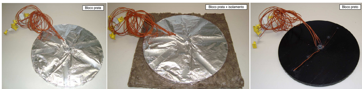
Figura 4.19 – Imagens dos blocos utilizados nos testes para determinação dos coeficientes de transferência de calor.
