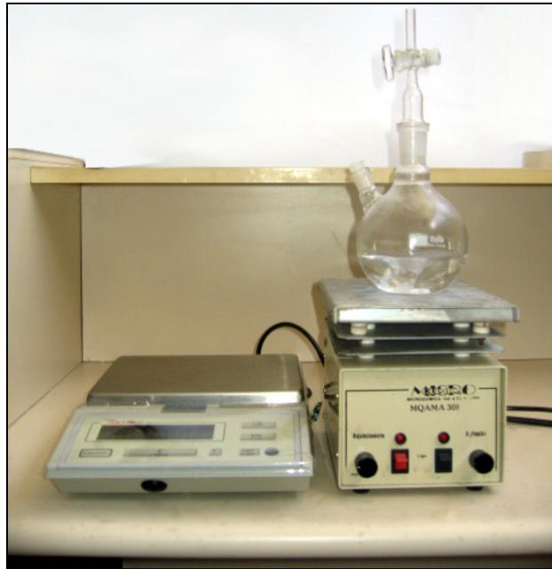
Figura 3.7 – Desgaseificação e pesagem do fluido
