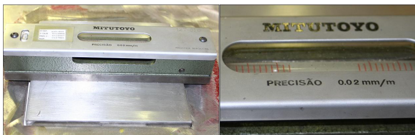
Figura 3.21 Verificação com nivelador de precisão de 0,02 mm/m, marca MITUTOYO.
