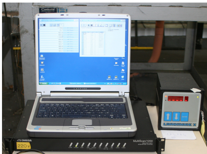
Figura 3.4 Sistema completo de aquisição de dados: Laptop e Omega OMB-Multiscan-1200.
