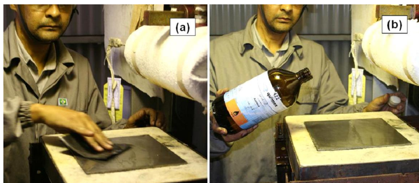
Figura 3.23 Limpeza superficial com lixa mesh 600 (a) e depois a aplicação da acetona (b).
