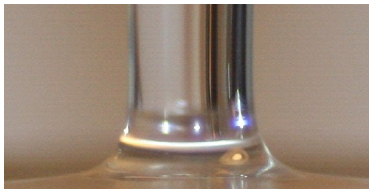
Figura 3.17 Fotografia do jato incidente de mostrando a abertura do cone inferior.
