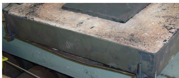
Figura 3.28 Empeno na parte inferior do suporte da placa de teste.
