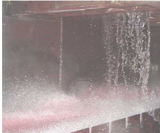
Figura 1.4 Ruptura da cortina d'água durante o resfriamento da tira, na Usiminas.
