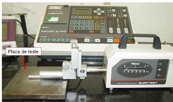
Figura 3.8 Rugosímetro modelo SURFTEST SV-400, fabricante Mitutoyo, verificando a rugosidade superficial da placa de teste.
