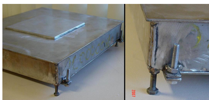
Figura 3.20 Suporte da placa com quatro parafusos para nivelamento no berço de resfriamento.
