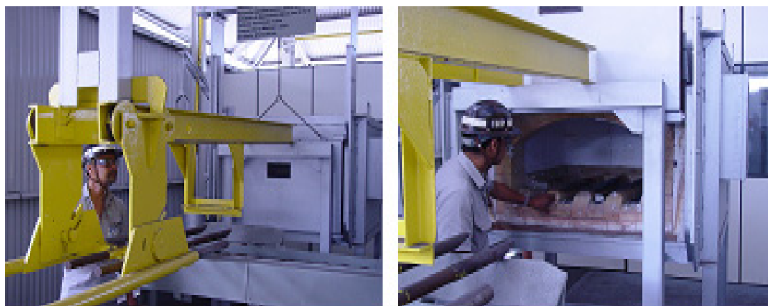
Figura 3.14 Forno Elétrico, com temperatura máxima de aquecimento de 1300°C e potência de 75 kW.
