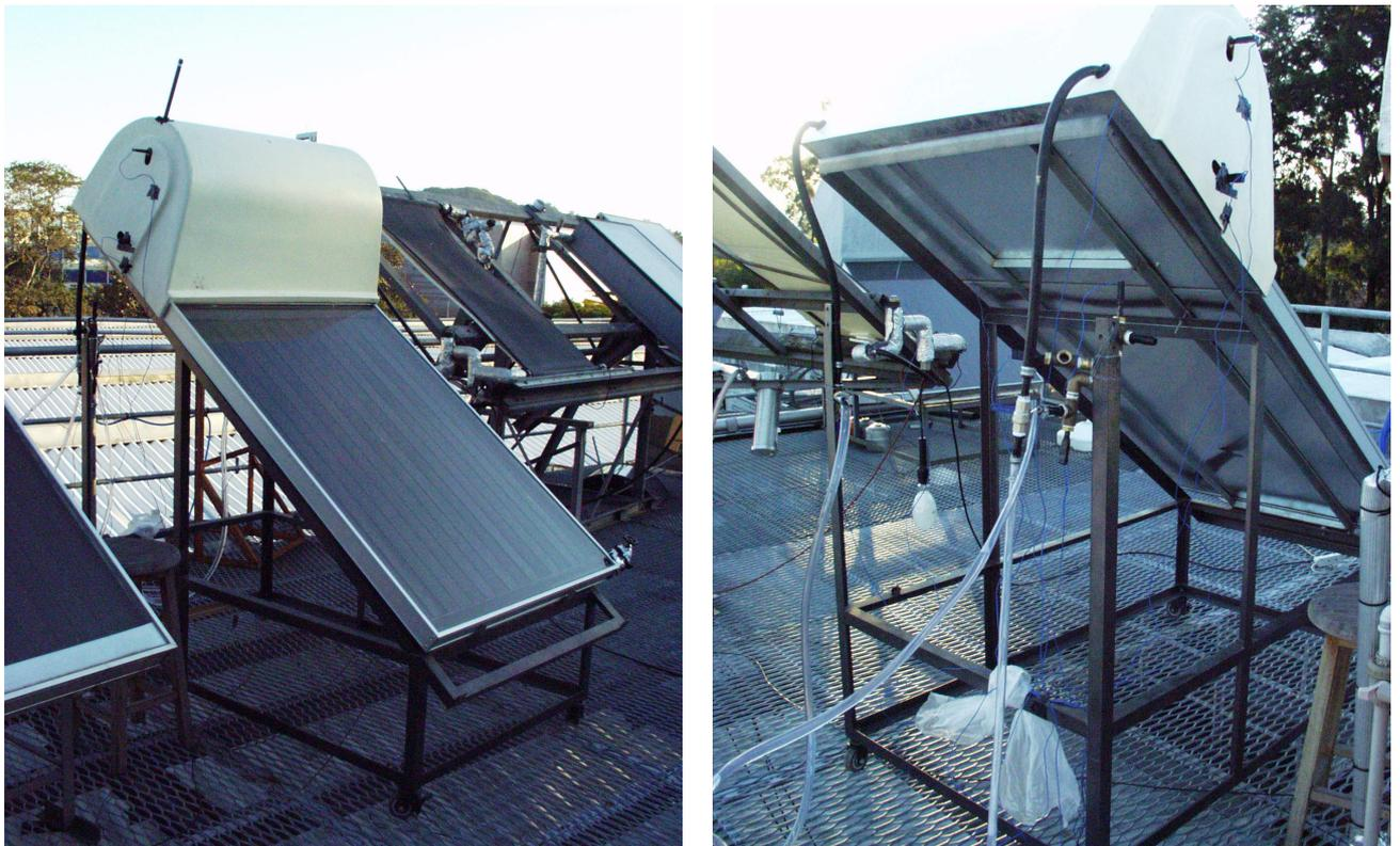
**Fig. 3.3 Coletor solar usado na validação experimental. Fabricante: Solares LTDA.**
