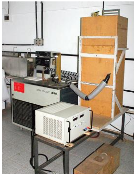
Figura 4.1 – Vista externa do tubo termossifão, do bloco de aquecimento e do calorímetro que envolve o condensador.
