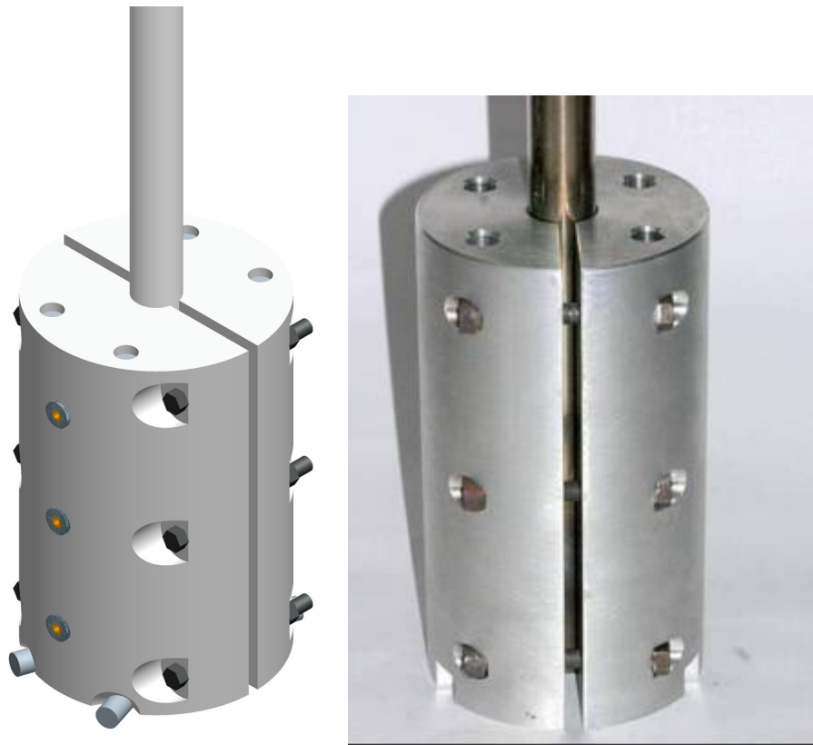
Figura 4.6 –Bloco de aquecimento do evaporador: (a) Croqui;
