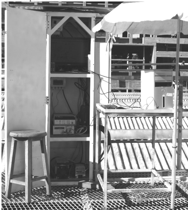
Figura 3.23 - Estação de controle da bancada
