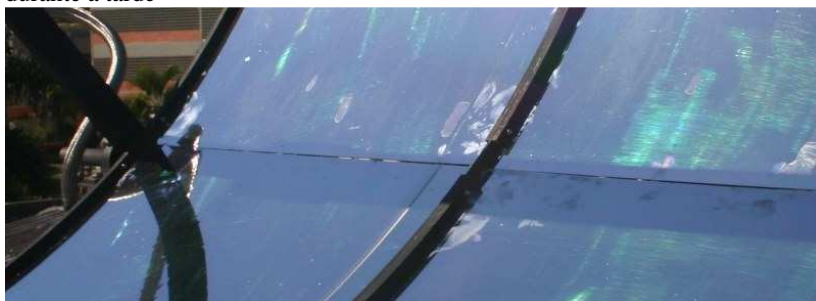
Figura 4.16 - Detalhe da sombra do elemento absorvedor no final do coletor durante a tarde
