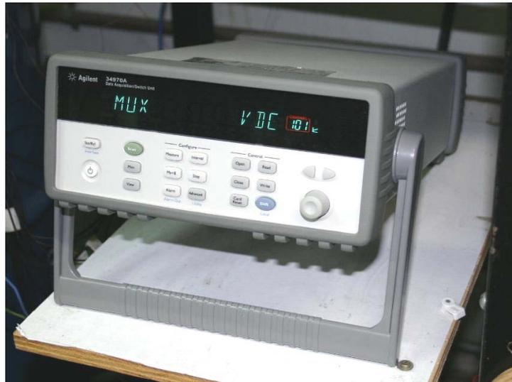
**Figura 4.4 – Unidade de aquisição**
