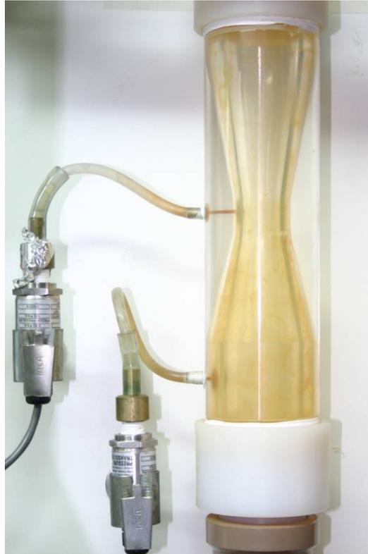
Figura 4.5 – Detalhe tubo Venturi
