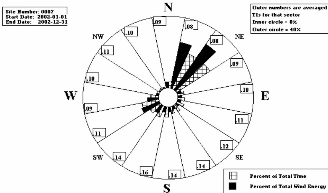
Figura 3: Gráfico da Rosa dos Ventos referente à Estação 007 – Água Doce, para medições realizadas no período de 01/01/2002 a 31/12/2002
