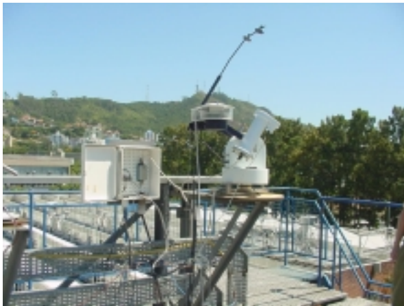
Fig. 5. Pirheliômetro de Hickey Frieden montado sobre o rastreador solar SM3 da Eppley Co., com detalhe da caixa de conexão de calibração.
