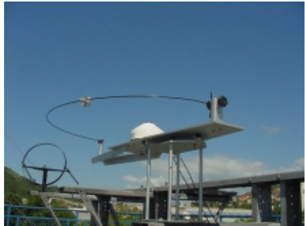
Fig. 7. Bancada de calibração de piranômetros pelo método da soma, mostrando o piranômetro Kipp&Zonen CM22.
