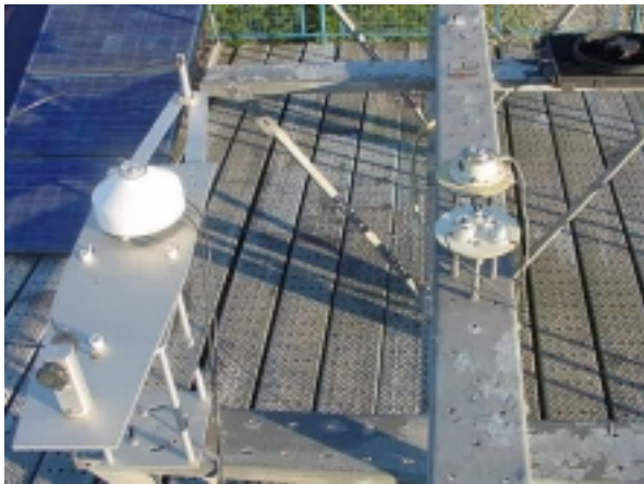
Fig. 10. Calibração dos piranômetros pelo método da comparação, tendo como referência o piranômetro Kipp&Zonen CM22 ventilado (à esquerda).
