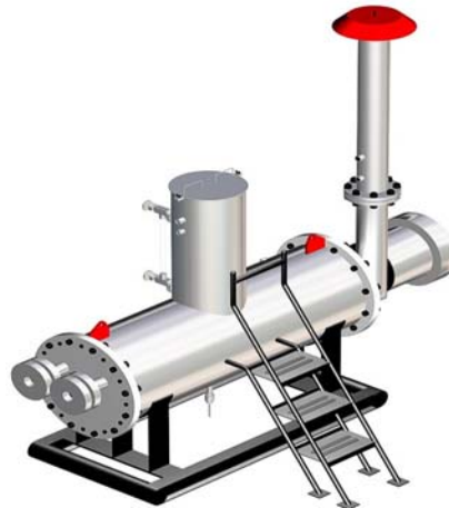
Figura 1. Aquecedor convencional de Gás Natural (por convecção natural com água)
