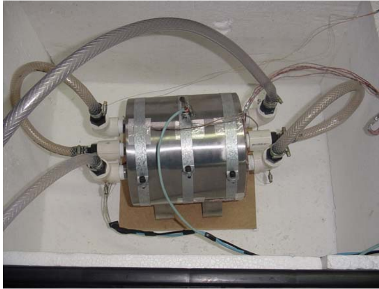
Figura 4. Modelo em escala reduzida do trocador de calor
