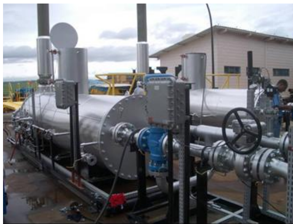
Figura 1. Foto de dois aquecedores de banho líquido, fonte: [3]
