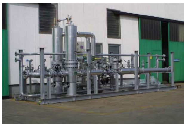
Fig. 5 Exemplo de aquecedor de passagem, com a potência fornecida pela queima de gás, fonte [2].
