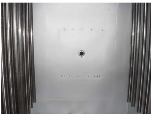
Fig. 3. Vista dos termossifões dentro da câmara de cocção
