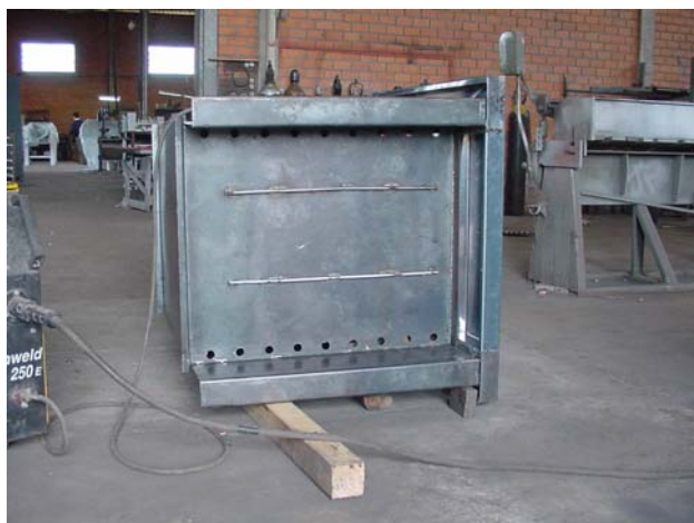
Fig. 4. Vista inferior do forno, com espaço para a instalação dos termossifões e câmara de combustão.
